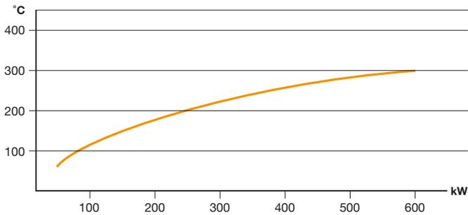
— = La capacidad de refrigeración a 12°C de temperatura del agua de refrigeración, dependiendo de la cantidad de agua de refrigeración y el flujo de aceite efectivo, es posible que haya fluctuaciones hacia arriba y hacia abajo.
