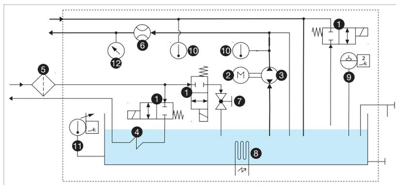
1 Valvola a 2-2 vie (normalmente chiusa), 2 Motore della pompa, 3 Pompa con direzione di pompaggio reversibile, 4 Serpentina di raffreddamento, 5 Filtro, 6 Sensore di flusso, 7 Valvola a sfera, 8 Resistenze elettriche, 9 Sensore del livello, 10 Sonda della temperatura, 11 Termostato di sicurezza, 12 Sensore di pressione
