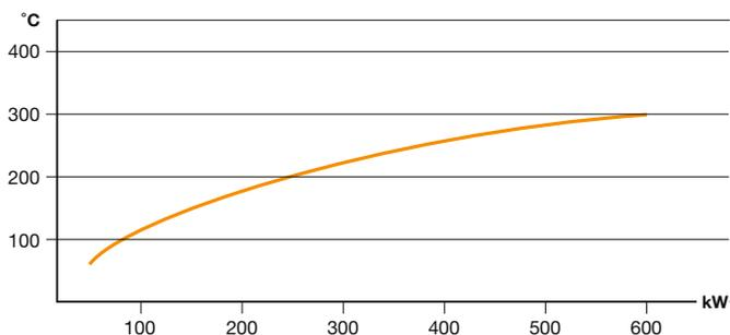
— = Capacité de refroidissement à une température d'eau de refroidissement de 12°C, en fonction de la quantité d'eau de refroidissement et du débit d'huile effectif, des fluctuations vers le haut et vers le bas sont possibles.
